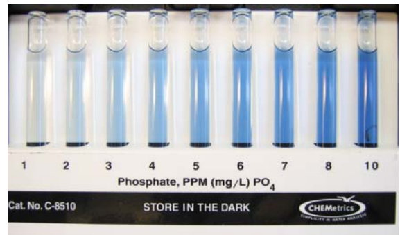
Photo 3. Gamme d'étalons liquides colorés fabriquée par CHEMetrics
