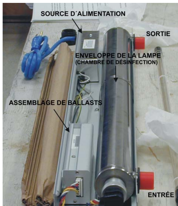
Figure 3: Schéma de l'appareil de traitement UV avec le couvercle enlevé
