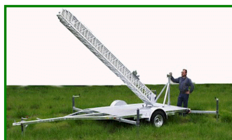
Tour transportable sur remorque
