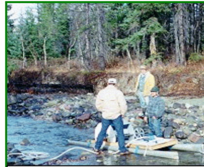
Prototype de pompe flottante (roué à aubes)
