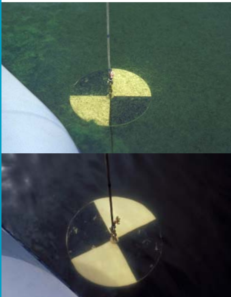
Un disque de Secchi montre l'eau d'étang-réservoir avant et après un traitement au cuivre.
